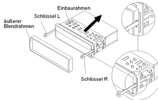
Um das Gerät wieder auszubauen, nehmen Sie zunächst den Blendrahmen ab und führen Sie den rechten und den linken Schlüssel in den jeweiligen Schlitz an der Seiten des Gerätes ein. Die Laschen sind nun zurückgebogen und Sie können das Gerät herausziehen.
